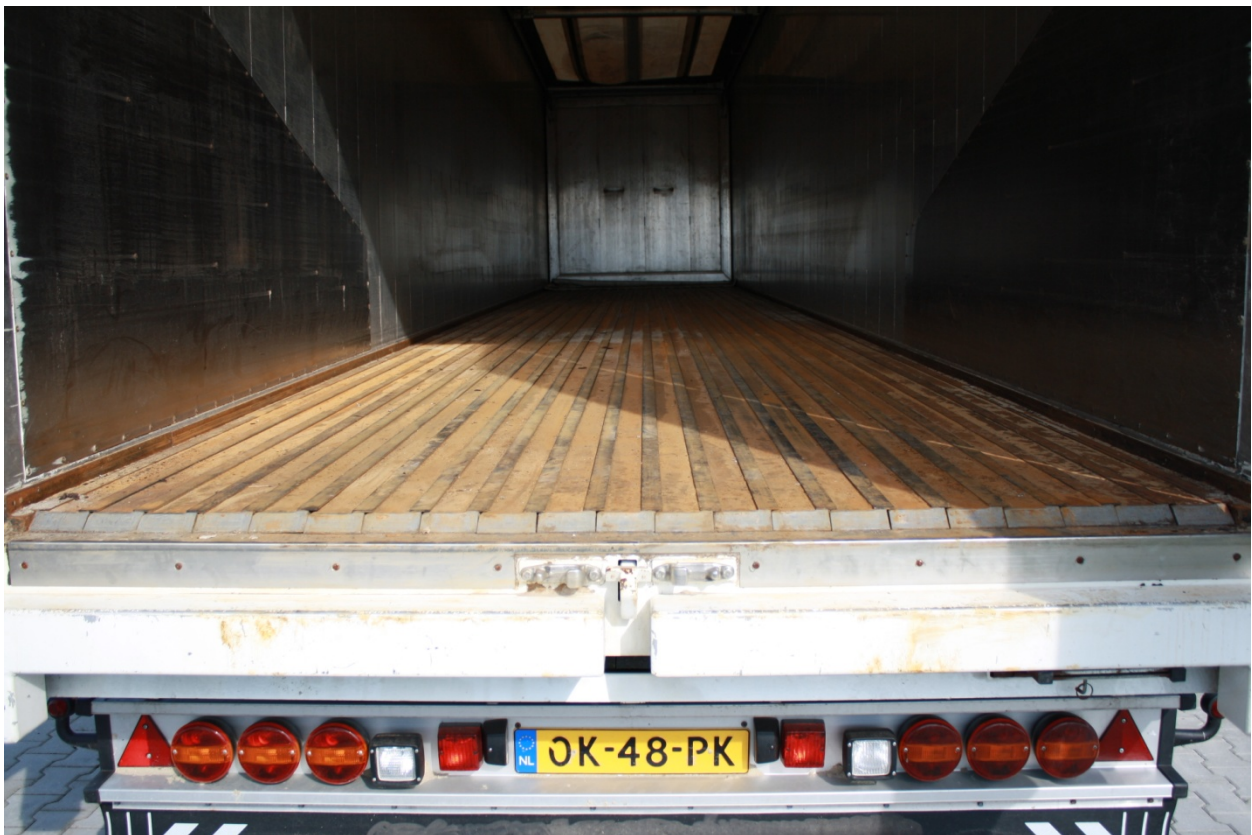
Stählerne C-Profilboden ohne Gummidichtungen, aber mit stählerne Überlapp.
